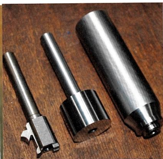
Zadnji trije »koraki« izdelave vitalnega dela vsakega strelnega orožja: na desni hladno kovani surovec, na sredini cev, postružena na zunanje dimenzije, in levo cev, kakršna bo po zaključeni strojni obdelavi.
