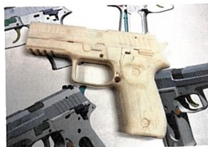
Model, ki so ga v zgodnji fazi razvoja »natisnili« tridimenzionalnem tiskalniku, pod njim so 3D modeleri, prav tako ena zgodnejših faz v razvoju no pištole.
