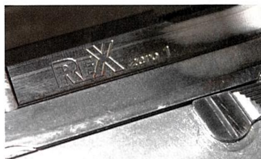
Zaklep brez končne obdelave, a z vgraviranim napisom, na prav tako nedokončanem ogrodju sodi v izpopolnjevanje postopka sestavljanja pištole med pripravami na serijsko proizvodnjo.
