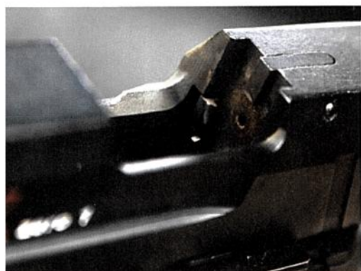
Detajl čela zaklepa nam razkrije notranji izvlečnik in pa nepogrešljiv kazalnik polnega ležišča naboja.
