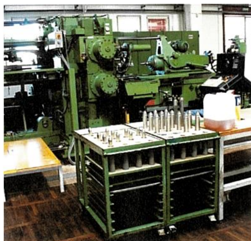
Bistveni element izdelave cevi je ponovno usposobljen stroj za hladno kovanje, iz katerega že prihajajo tudi prve pištolske cevi kalibra 9 milimetrov.
