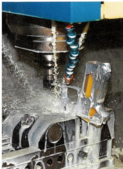
Takole v drugi fazi obdelave, ki poteka popolnoma avtomatizirano, iz bloka aluminija počasi nastaja ogrodje pištole, ki ga čakata še končna in površinska obdelava.
