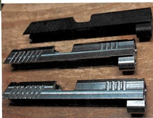
Zaklepi za pištolo zero 1 standardne velikosti v različnih fazah končne obdelave, ki prav tako v celoti poteka v Arexovi tovarni.
